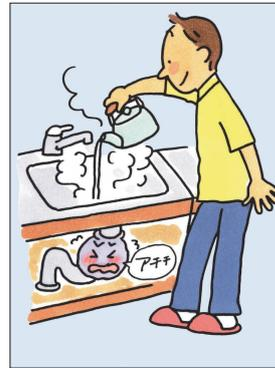
排水管にはほとんどの場合塩化ビニル樹脂が使用されており、熱いお湯を流すと、排水管が破損したり変形したりすることがあります。45度以上の熱湯は流さないようにしてください。
