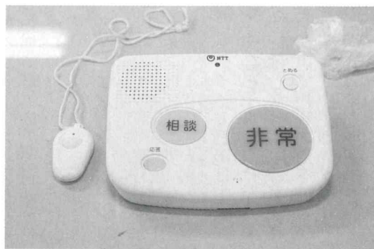
緊急通報システム本体装置とペンダント
